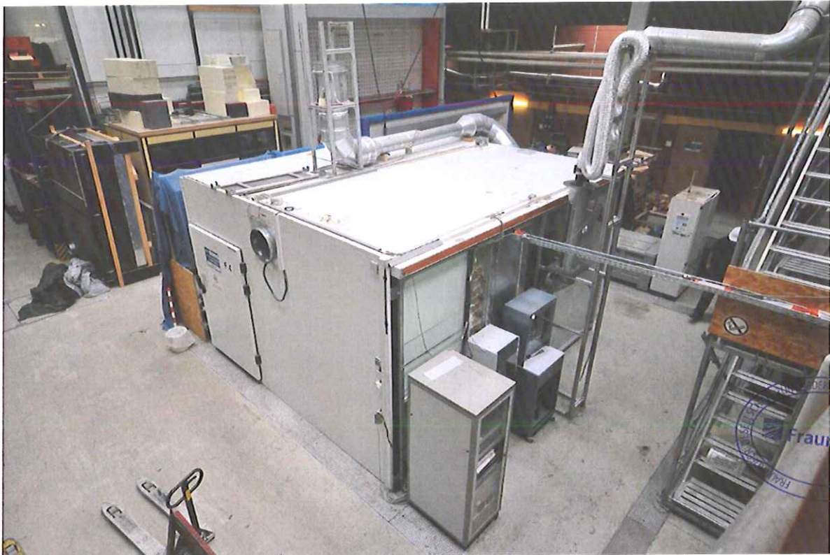
Abbildung 2: Technische Versuchseinrichtung (Kalorimeterraum) zur Bestimmung von Energiebilanzen.
